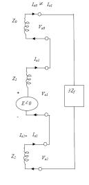
(ii). LINE TO LINE FAULT (L-L FAULT)
